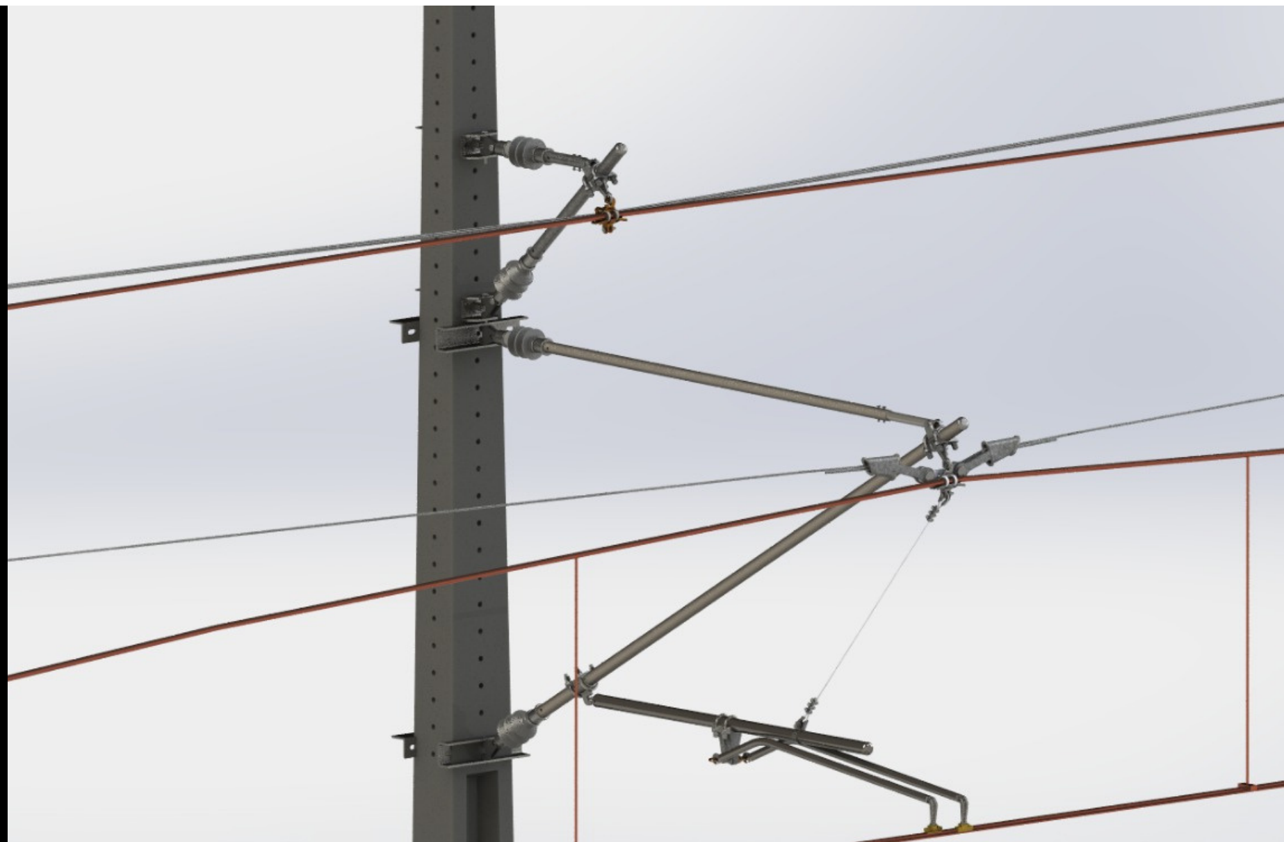
PONTO FIXO REDE AÉREA DE TRAÇÃO 3KVCC
